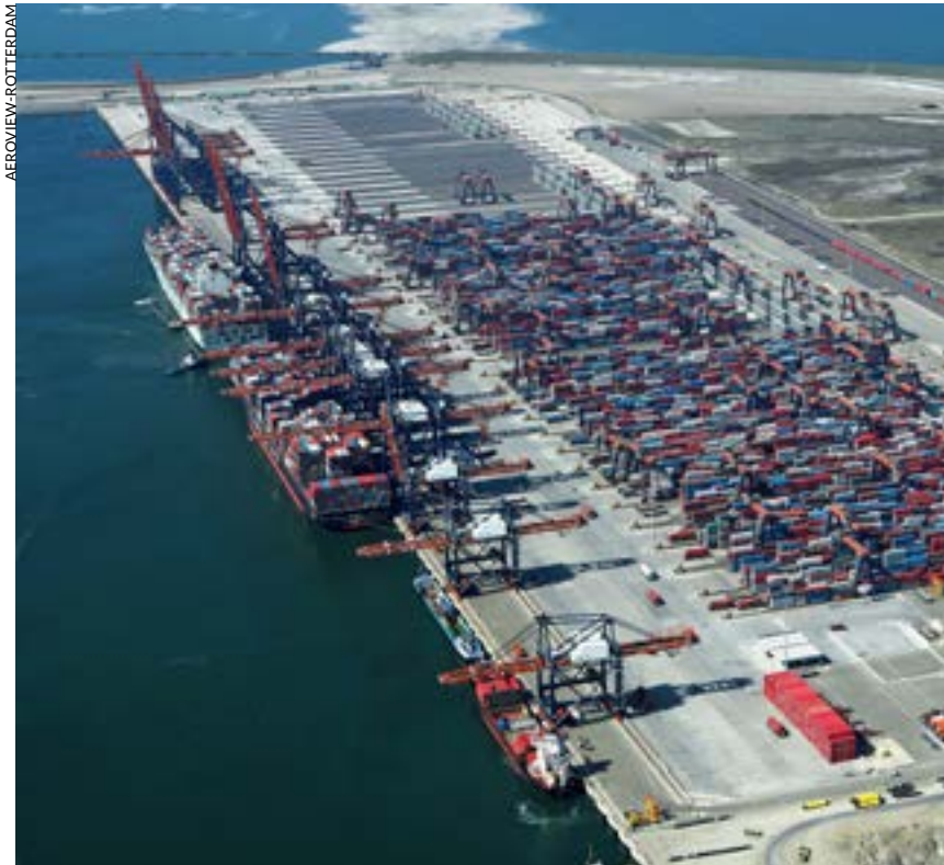
Le port de Rotterdam s'agrandit en gagnant sur la mer. Le terminal Euromax traite depuis dix ans les très gros porte-conteneurs de façon semi-automatisée, notamment pour charger les camions (ici en 2016).
